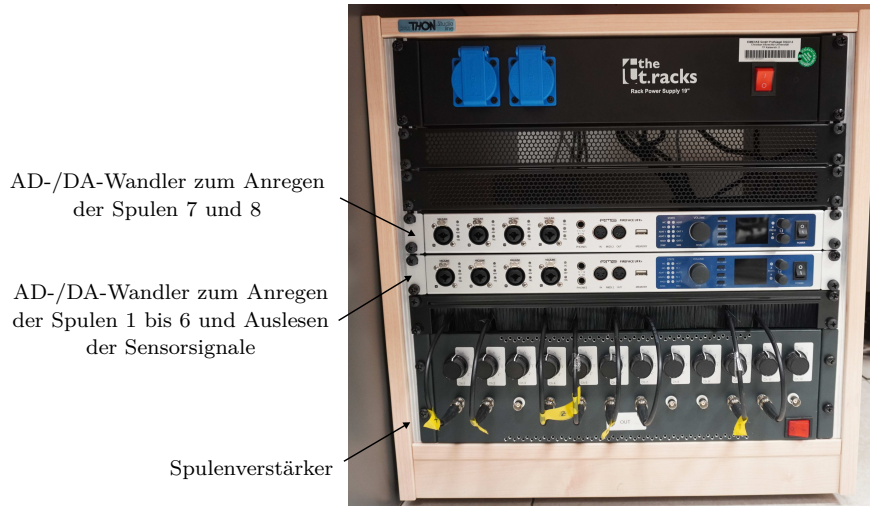
Abbildung 6.2: Anrege-/Ausleseelektronik für die Lokalisierung. Es werden hier zwei Soundkarten parallel verwendet.
