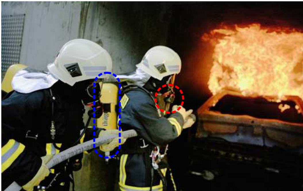
Abbildung 2.2: Atemschutzeinsatz (Lungenautomat in Rot, Flasche des Pressluftatmers in Blau).
