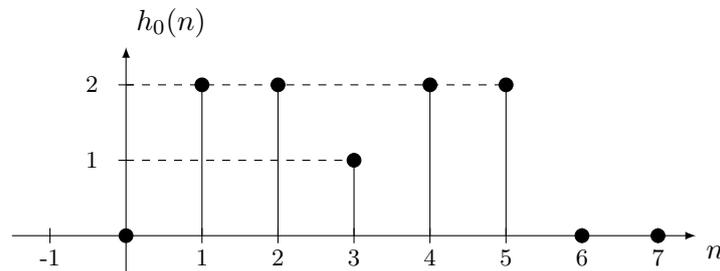
Abbildung 4: Impulsantwort  $h_0(n)$  für  $n \in [0, 7]$  des diskreten, reellwertigen Systems.
