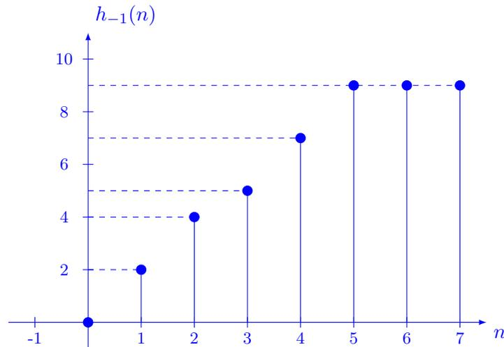
Abbildung 5: Sprungantwort  $h_{-1}(n)$  für  $n \in [0, 7]$  des diskreten, reellwertigen Systems.
