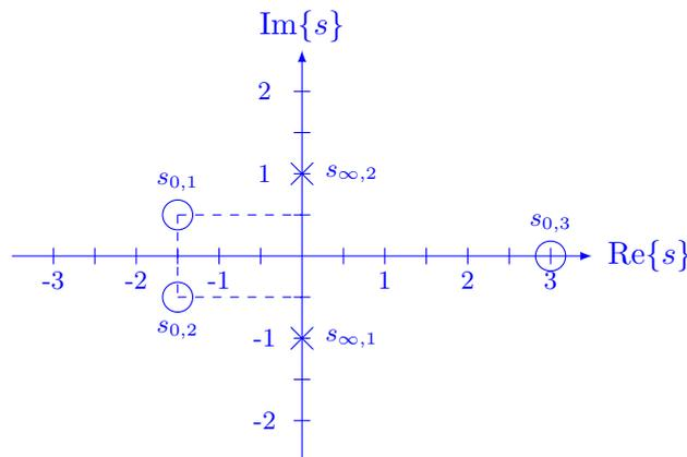
Abbildung 3: PN-Diagramm des gegebenen Systems.
