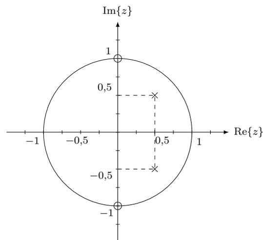
Abbildung 2: Pol-Nullstellen-Diagramm des Systems  $H_2(z)$ .
