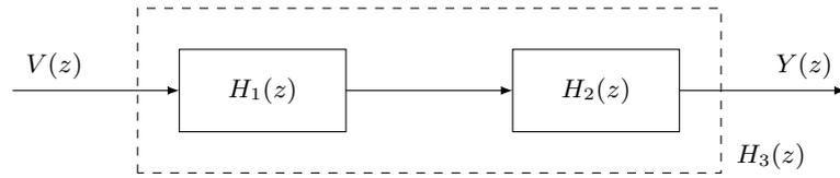
Abbildung 3: Reihenschaltung der Systeme  $H_1(z)$  und  $H_2(z)$ .
