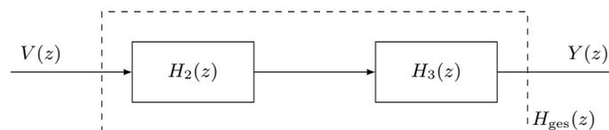
Abbildung 3: Reihenschaltung der Systeme  $H_2(z)$  und  $H_3(z)$ .
